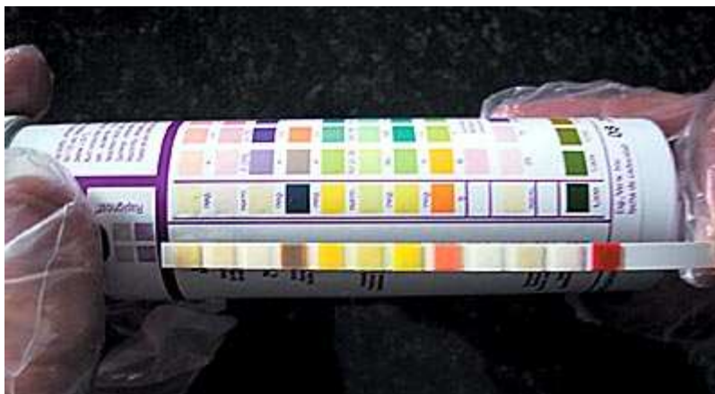
Ryc. 1.1. Pasek testowy i porównawcza skale barwne do odczytu przybliżonych stężeń różnych analitów w moczu
