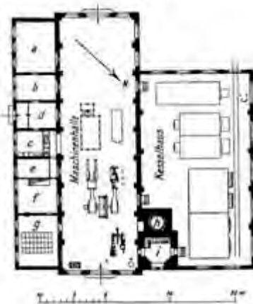
Rzut Laboratorium Maszynowego
