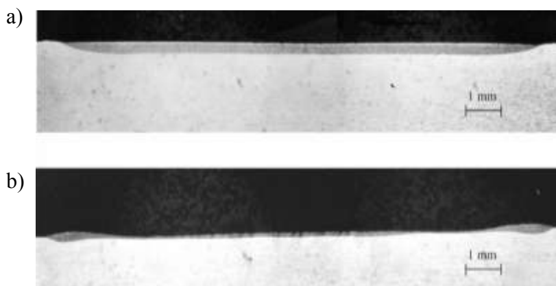
Rys. 3.19. Przekrój poprzeczny ukazujący geometrię pola przetopu uzyskaną przy prędkości skanowania: a) 500 mm/min, b) 1000 mm/min [81]
