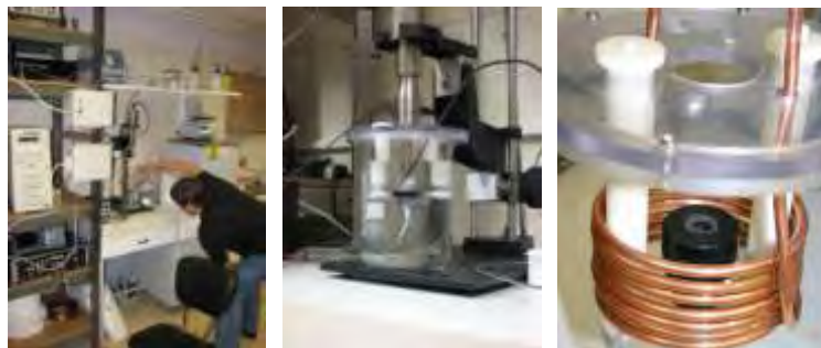
Rys. 12.13. Widok ogólny stanowiska, komora robocza bez układu chłodzenia, oprawa próbki [132]
