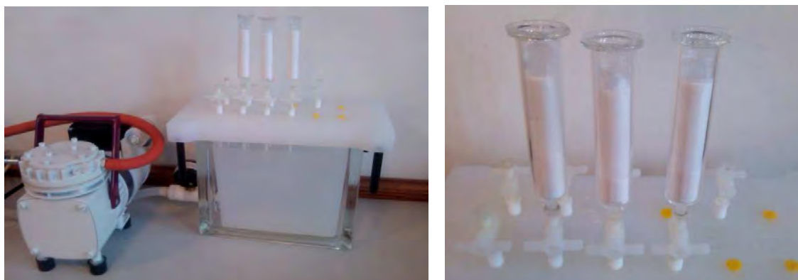
Rys. 13. Widok ogólny zestawu ekstrakcji do fazy stałej (SPE) wykorzystanego na etapie oczyszczania ekstraktów rozpuszczalnikowych otrzymanych z próbek kurzu
