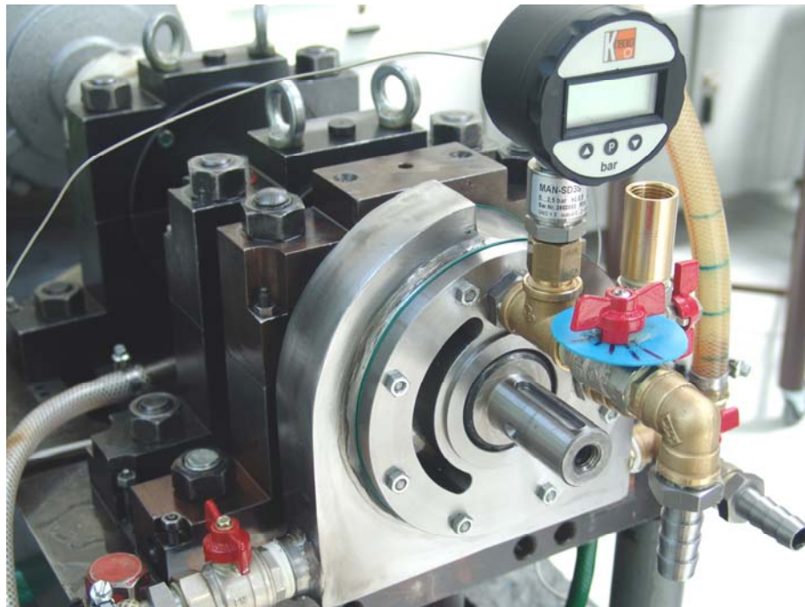
Rys. 124. Konfiguracja maszyny łożyskowej PGII – 1Ł z przystawką badawczą jako wyodrębnionym klasycznym układem zasilania pierścieniem stałym
