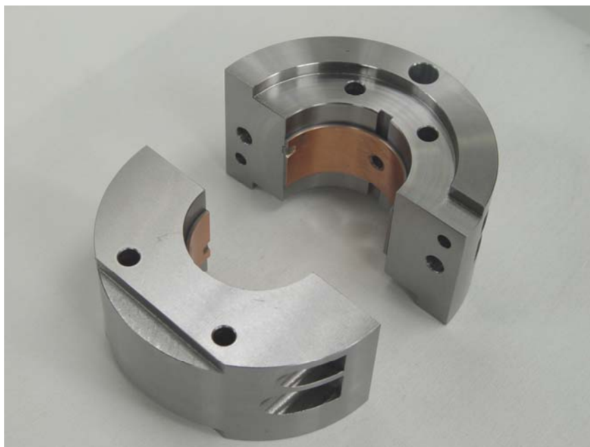
Rys. 62. Specjalna oprawa łożyska badanego współpracująca z przystawką badawczą
