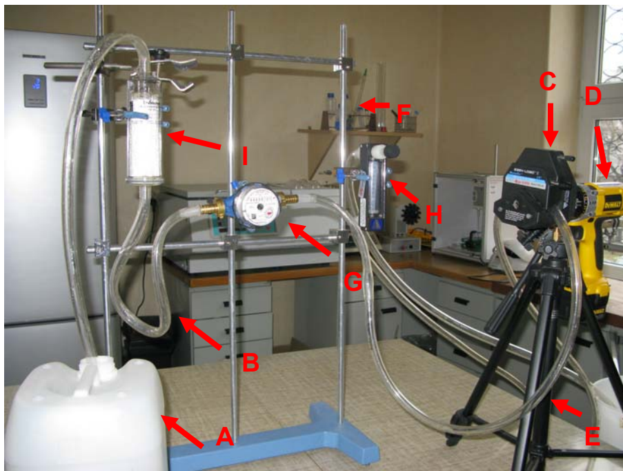
Rycina 9. Zestaw do filtrowania wody: A) 10 L pojemnik polietylenowy na wodę, B) wąż igielitowy, C) głowica pompy perystaltycznej D) przenośna wiertarka akumulatorowa DEWALT, E) statyw na pompę, F) statyw do umocowania filtra i przepływomierza, G) przepływomierz, H) manometr I) filtr kapsułkowy Envirochek
