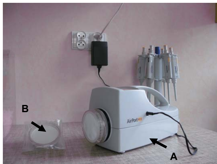
Rycina 8. Zestaw do pobierania prób powietrza. A) AirPortMD8 (Sartorius), B) Filtry żelowe (Sartorius AG, Germany).
