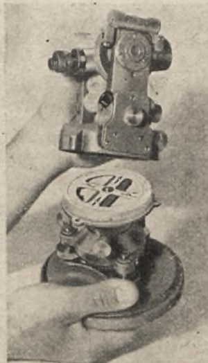
Rys. 6. Nowoczesna busola okrętowa (przez okienko widać busolę)
