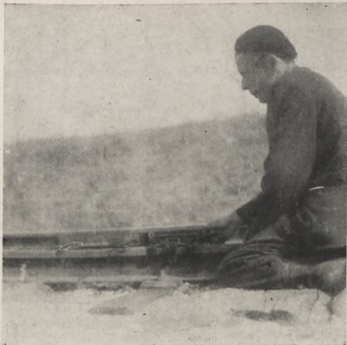
Rys. 5. Zaczep z dynamometrem do naciągania taśmy mierniczej na szynie kolejowej w czasie pomiaru
