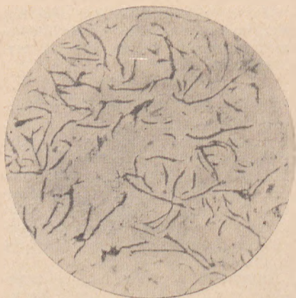
Rys. 1. Przekrój żeliwa szarego, szlif nie trawiony, powiększenie 100-krotne. Widoczne liczne żyłki grafitu, wiążące się ze sobą
