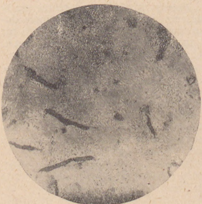
Rys. 2. Przekrój żeliwa modyfikowanego o dużej wytrzymałości, szlif trawiony kwasem azotowym, powiększenie 300 razy, widać poszczególnie, luźne żyłki i kulki grafitu, nie złączone ze sobą
