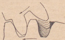
Schemat zazębienia kół zębanych
