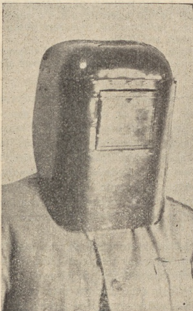
Rys. 3. Osłona odchylna w położeniu roboczym.
