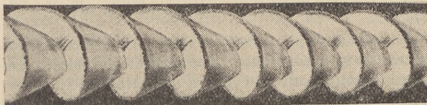
Rys. 2. Kształt wióra otrzymany podczas skrawania nożem z rowkiem kierującym.
