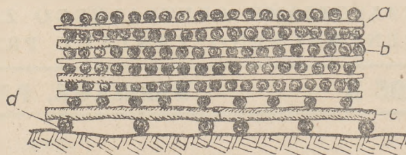
Rys. 2. Rozluźniony stos suszący: a) przekładka, b) składowane drewno, c) legar poprzeczny, d) legar podłużny.
