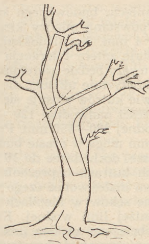
Rys. 3. Zastosowanie krzywego drewna w skutnictwie (wg Häringa).
