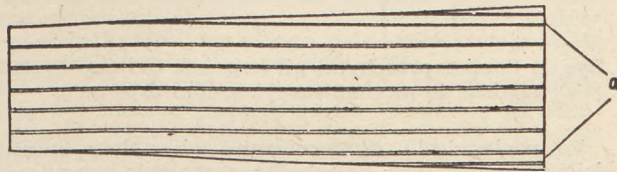
Rys. 1. Schemat przetarcia kłody — widok z góry. Wskutek zbieżności deski boczne oznaczone literą a stanowią króciaki
