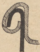
Rys. 3. Wygląd zakładki po pierwszej fazie zamykania przy nieprawidłowym działaniu rolki zawijającej (zakładka niedociśnięta).
