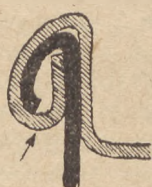
Rys. 4. Wygląd zakładki po pierwszej fazie zamykania przy nieprawidłowym działaniu rolki zawijającej (zakładka zbyt dociśnięta).
