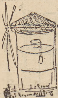
Wiatrak. Sciany z kamienia. Dach obrotowy.
