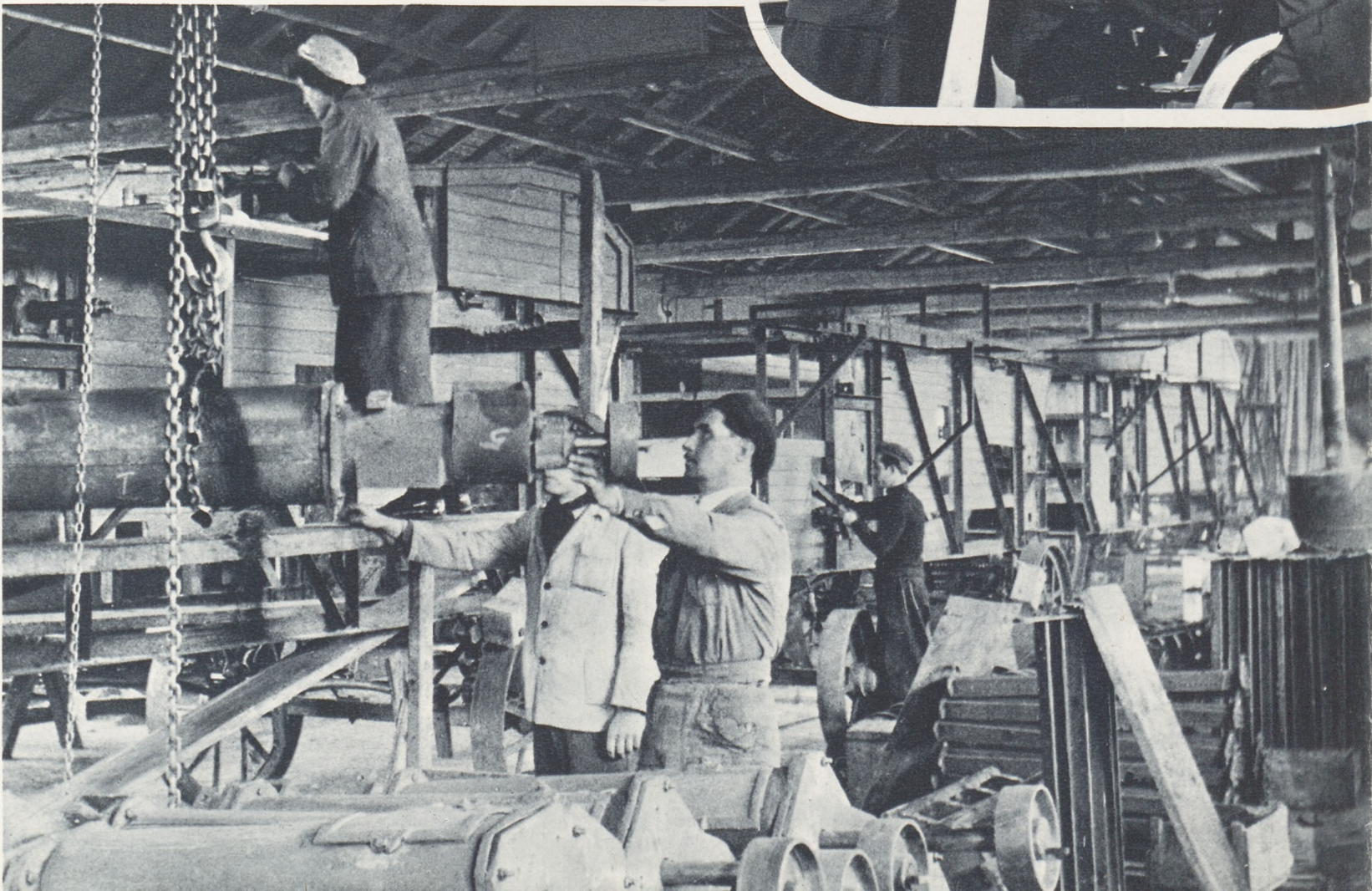
В молотильном цехе, под руководством мастера-орденосеца Стояна Нецова проводится сборка молотилок.
