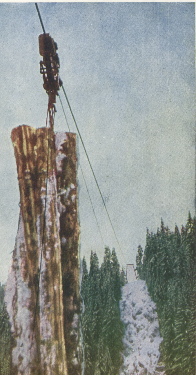
Воздушная линия в местности „Мечо дере“ Пенгерской околии. По новой линии доставляется древесный материал с неприступных горных лесозаготовок. Она проходит через высокие пихтовые и еловые леса, обслуживается шестью рабочими и заменяет 20 пар волов или лошадей с соответствующим числом людей.
