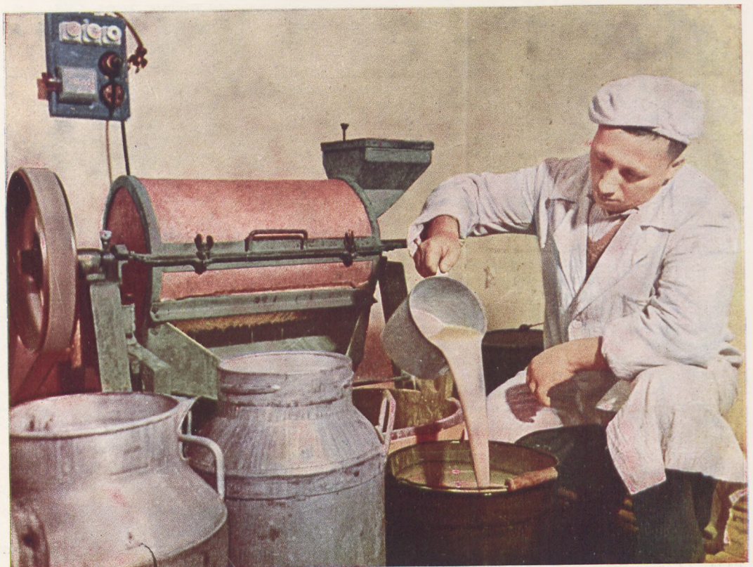
Кондитерский отдел комбината располагает электрической машиной (болгарского производства) для приготовления бузы.
