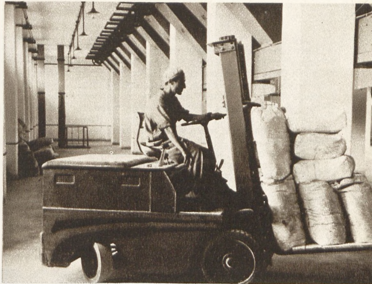
Советский транспортер „ЗИО“ может перевозить до полутора тонн груза и поднимать его на 2½ метра.
