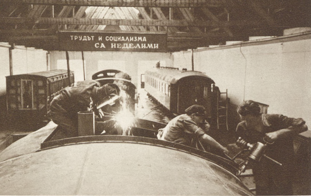
Сварка и клепка крыши нового спального вагона.
