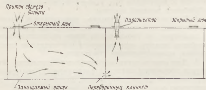
Рис. 3. Схема вентиляции отсека баржи при зачистке
