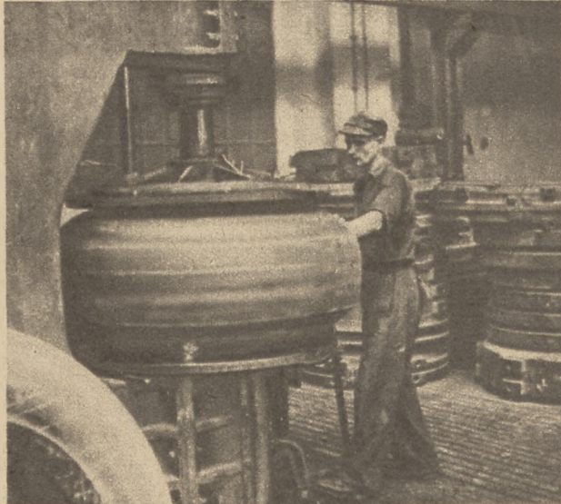
Aby rura, która ma być oponą zmieściła się w formie wulkanizacyjnej spłaszcza się ją pod ciśnieniem wielu atmosfer w maszynie zwanej „eksponderem”.
