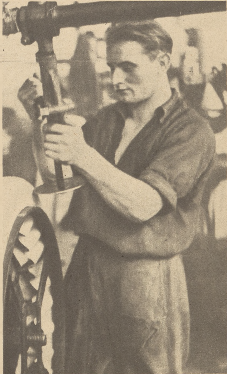
Opona w pierwszej fazie produkcji — to przede wszystkim tkanina. Później dopiero na specjalnym kalandrze oblepi ją czarna masa kauczukowa. „Stomilki” są już prawie gotowe.
