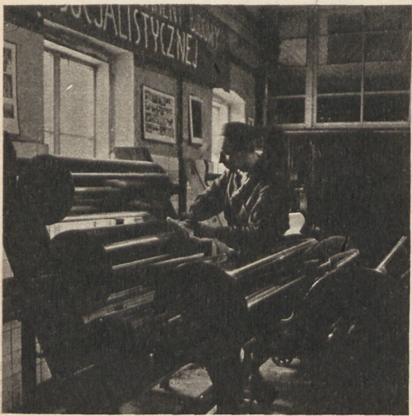
Oto gładkie, idealnie wypolerowane walce miedziane. Na nie przenosi się wizerunek kolumn druku, które później maszyna rotacyjna odbija na papierze.
