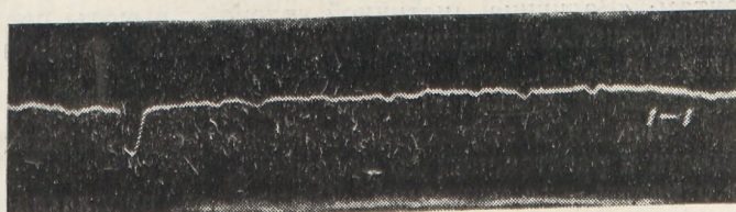
Рис. 9. Профилограмма шейки вала дизель-динамо после эксплуатации
