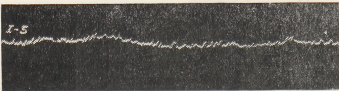
Рис. 5. Профилограмма шейки коленчатого вала после шлифовки
