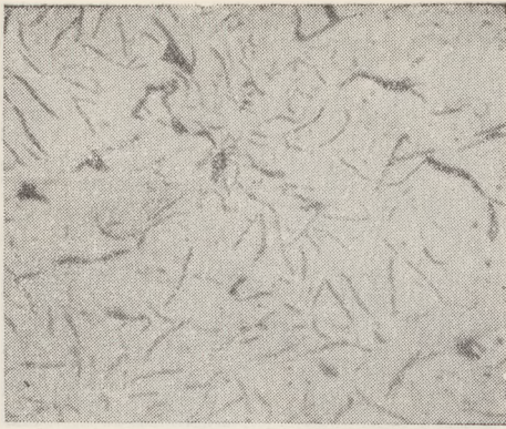
Удовлетворительная. Графит тонкопластинчатый, завихренный (ув×100)
