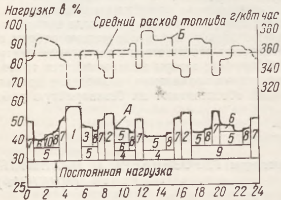
Рис. 2. Графики нагрузки электростанции в ходовом режиме судна А и расхода топлива Б с расписанием включения вспомогательных механизмов:
