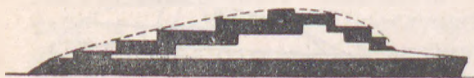
Рис. 6. Композиционный блок судна, К.а.д., примененная для конструктивного и фальшбортного блока надстроек без учета носовой части судна
