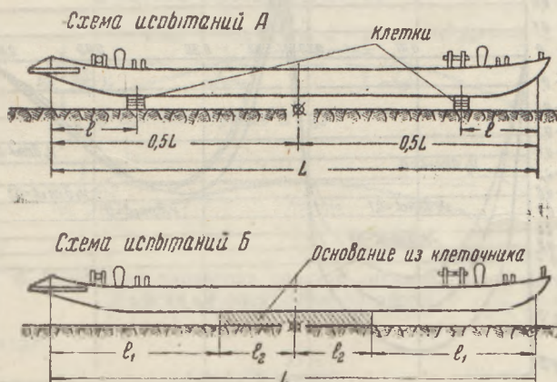
Рис. 1. Схемы испытаний баржи на клетках
