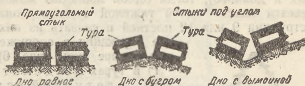
Рис. 3. Стыки смежных тур при первоначальной их укладке
