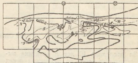
Рис. 4. План деформаций протока с межи 1944 г. по межень 1945 г.
