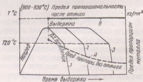
Рис. 2. Понижение предела пропорциональности в результате перегрева металла (линия А) и возможность его увеличения отжигом (линия В)
