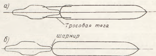
Рис. 1. Способы скрепления: а — жесткий, б — шарнирный с ограничителями (рис. 2), а также шарнирнорегулируемый способ скрепления.
