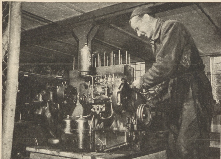
CAF Warsztaty Technicznej Obsługi Rolnictwa kończą ostatnio remonty sprzętu przed zbliżającymi się siewami wiosennymi. Przewodzący monter zakładów TOR w Gorzowie Wlkp. kończy właśnie przegląd silnika traktorowego K. D. 35.
