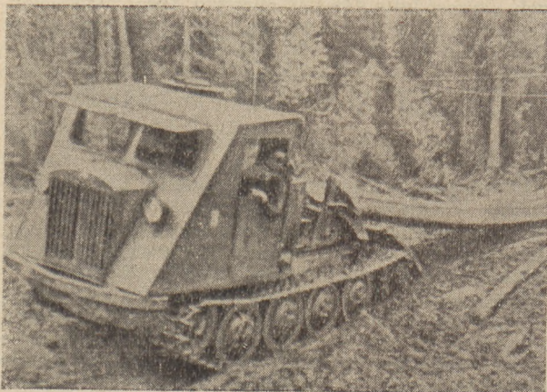
Ciągnik gaśnicowy KT-12 o napędzie gazgeneratorowym przy pracy w lesie
