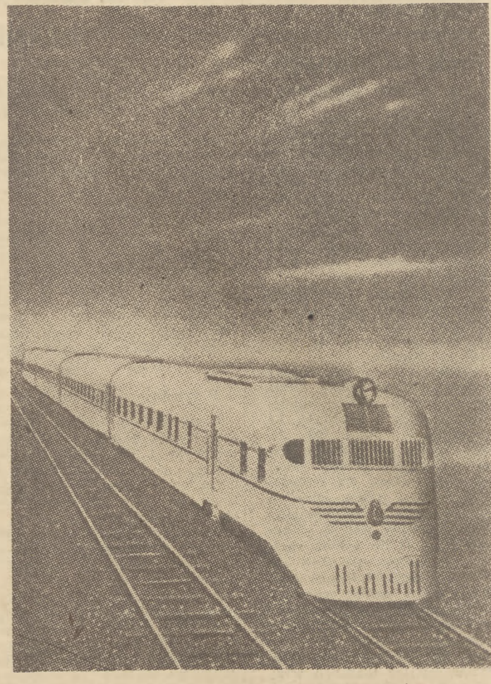
MAV (Węgierskie Koleje Państwowe) wprowadziły nowy pociąg motorowy napędzany olejem gazowym. Pociąg ten przeznaczony jest również na eksport. Osłaga on szybkość 100 km na godzinę i zaopatrzony jest w nowoczesne urządzenia wentylacyjne. Produkcją jego zajmuje się Fabryka Wagonów Ganz
