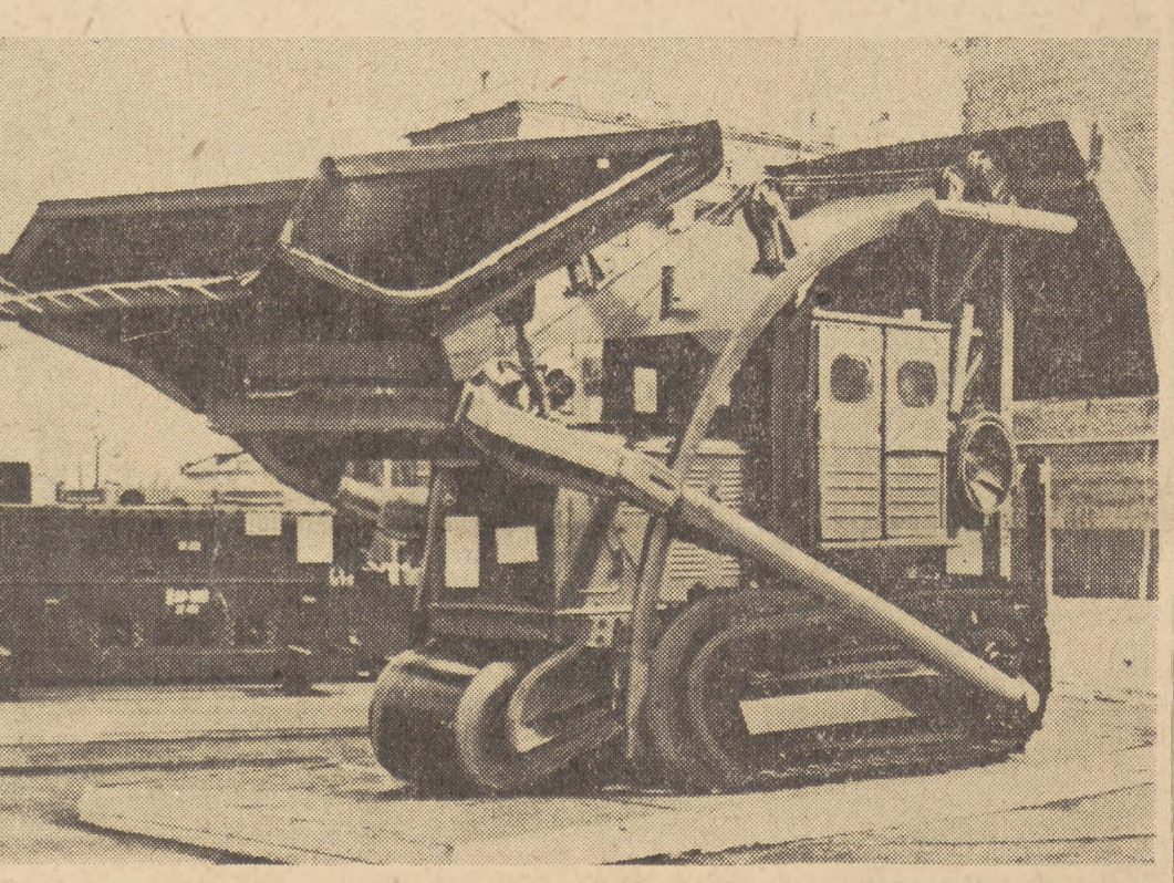
Ładowarka traktorowa „T-107“ o pojemności 4-6 metrów sześciennych. Foto CAF
