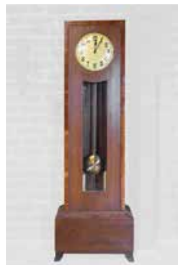
Zegar podłogowy z ok. 1930 r., firmy Mauthe. Zegar z wychwytem Grahama, wahadło sekundowe, mechanizmy bicia kwadransów (kurantowy) i bicia godzin. Zegar z automatycznym podciąganiem ciężarów motoreduktorem elektrycznym, co było w tamtych czasach rozwiązaniem awangardowym. Zegar подарował do muzeum Sławomir Drożdżewicz /własność MG/
