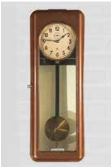
Zegar wahadłowy z ok. 1960 r., z renomowanej wytwórni niemieckiej TELEFONBAU und NORMALZEIT (TN GmbH). Zegar sterujący pracą sieci czasu /użyczony/
