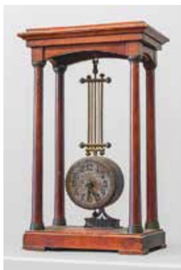
Budzik wiszący z przełomu XIX/XX wieku, z firmy Gustaw Becker. Rozwiązanie konstrukcyjne unikatowe. Oscylatorem jest sam mechanizm zegara kołyszący się ruchem wahadłowym na zawieszaniu, a napęd bierze się z wewnętrznej sprężyny mechanizmu. Zegar ten ilustruje ideę zegara Heweliusza. (Jedyny taki model Beckera) /własność MG/
