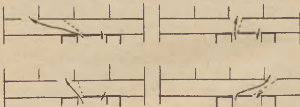
Rys. 5. Celowe urządzenie obory o 4-ch przedziałach i wspólnym pomieszczeniu (zbiorowym). Cztery możliwości przepędzania zwierząt
