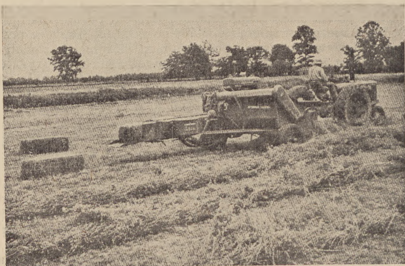
Rys. 11. Specjalna prasa „Pik up” zaopatrzona w wałek zbierający siano.
