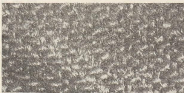
Ryc. 2. Dwie strony tej samej tkaniny wykonane splotem rzadkowym 3-nitkowym (silnie powiększone).
