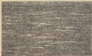
Rys. 9. Struktura włóknista walcowanej stali
