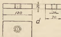
Rys. 18. Części składowe zszywarki: a) podstawa, b) śruby, c) listwa oporowa, d) nakrętki
