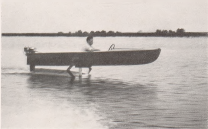
Abb. 4. Tragflächenboot in Fahrt auf dem Delaware-Fluß bei Philadelphia, USA. (1932). Geschwindigkeit 40 km/Stde. (System Tietjens).
