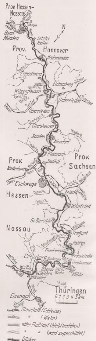
Abb. 2. Werra-Kanalisation von Hann.-Münden bis Wartha.
