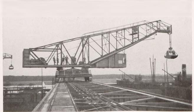
Abb. 4. Drehkran (Hedwigshütte Stettin) von 7,5 t Tragfähigkeit bei 25 m Ausladung mit eingebauter geeichter, selbsttätiger Wiegeschrank-Seilzugwaage. Wiegefähigkeit bis 5 t.
