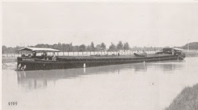
Abb. 26. Das erste mit Anthrazit-Gas betriebene Fluß- und Kanal-Frachtschiff „GS Hannover“ der Westfälischen Transport A.-G., Dortmund, gebaut 1936 auf der Arminius-Werft, Bodenwerder (Weser). Gaskraftanlage von der Humboldt-Deutzmotoren A.-G., Köln. Brennstoffverbrauch etwa 0,360 kg/PSsh bei einer Propellerleistung von 250 PS.
