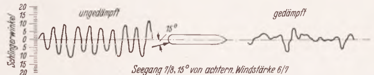
Abb. 33. Versuche mit Sperry-Schlick-Kreisel: Schlingerkurven bei achterlicher See.
