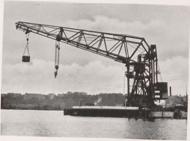
Abb. 15. 250 t-Schwimmkran Brest. Die mit 20 t belastete Laufkatze in äußerster Stellung (50 m von Pontonkante) bei ganz ausgelegtem Kranausleger.
