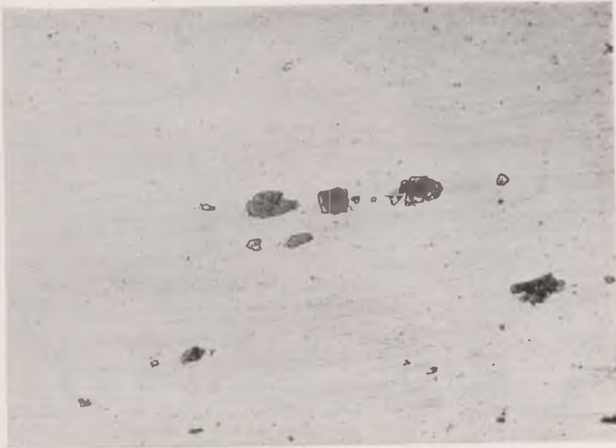
a) Homogener Gefügestand: gegläht bei 450° und abgeschreckt.
