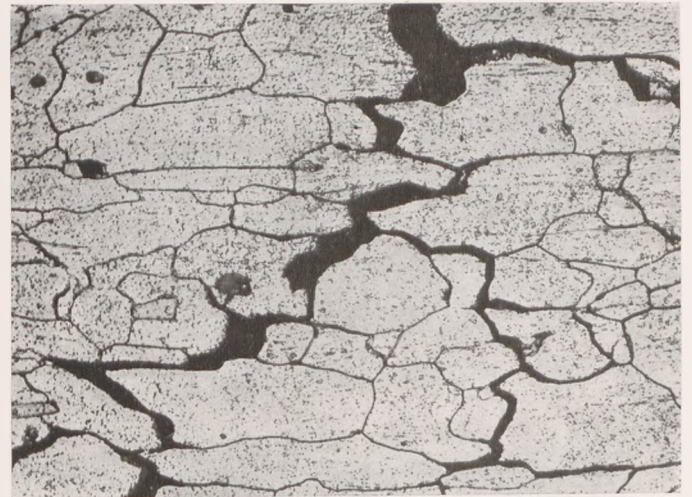
d) Interkristalline Korrosion entlang der fadenförmigen Ausscheidungen.
