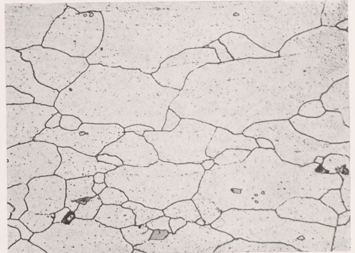
b) Fadenförmige Ausscheidungen an den Korngrenzen nach 3—4 tägigem Anlassen bei 100°
