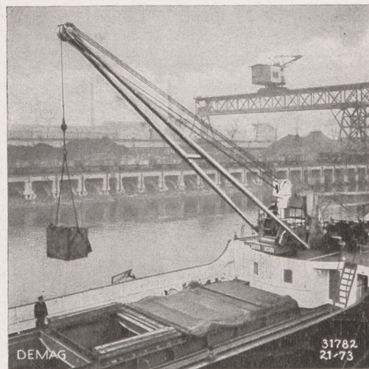
Abb. 12. Mit 3-t-Bordwippkran ausgerüstetes Rheineseeschiff.
