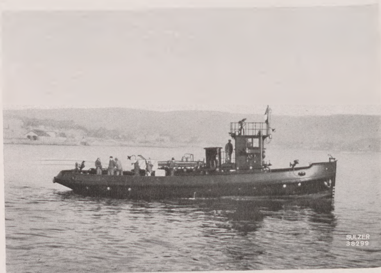
Abb. 3. Feuerlöschboot „Alarme“ im Hafen von Toulon, angetrieben von zwei Sulzer-Zweitaktmotoren von zusammen 220 PSe und ausgerüstet mit zwei Sulzer-Mitteldruck-Zentrifugalpumpen von je 30 l/s Fördermenge bei 120 m Förderhöhe und 70,5 PS Kraftbedarf.
