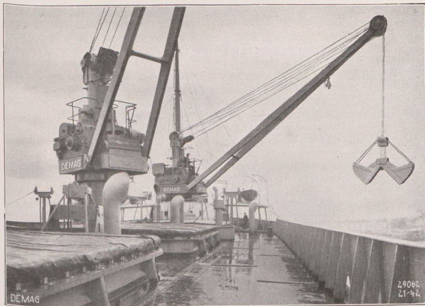
Abb. 11. Bordwippkrane auf dem M.-S. „Mülheim-Ruhr“. Das Schiff ist mit je vier Kranen für Stückgut und für Mehrseilgreifer-Betrieb ausgerüstet.
