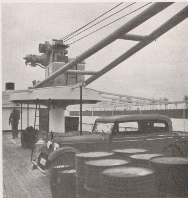
Abb. 13. Borddrehkran (Kampnagel) auf einem Binnenschiff. (Das Schiff wurde auf der Werft Christof Ruthof, Mainz-Kastel, erbaut).
